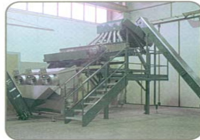
Linea di pelatura "brulage" a 6 forni completo di elevatore di carico e n° 3 pultrici tangenziali. / 6-oven "brulage" peeling line with loading elevator and 3 tangential cleaners.
