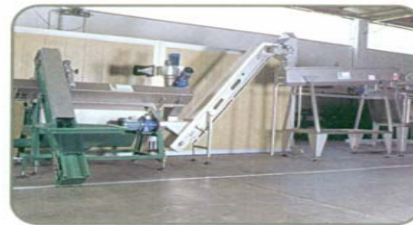
Linea di pelatura a vapore composta da elevatore di carico, inciditrice, elevatore in Intralox e coclea sbollentatrice. / Steam peeling line comprising loading elevator, scorer, Intralox elevator and parboiler worm.
