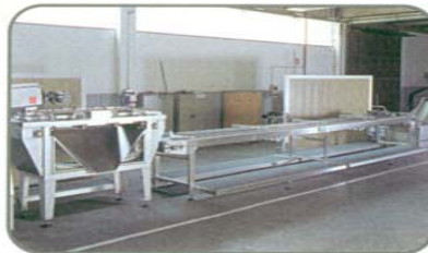
Parte finale della linea di pelatura a vapore composta da separapelli, nastro di finitura e cernita e vasca di lavaggio. / Final steam peeling line section composed of peel-separator, finishing and sorting belt, and washing tank.
