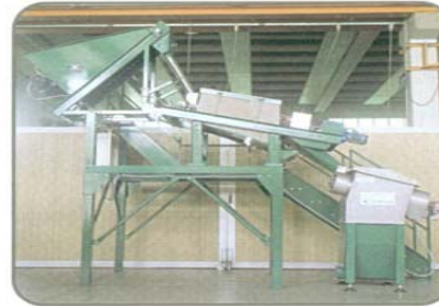
Impianto pilota per la pelatura "brulage" composto da dosatore a catena, n° 2 forni e n° 1 pultrice tangenziale. / Pilot "brulage" peeling plant comprising chain batcher, 2 ovens and 1 tangential cleaner.
